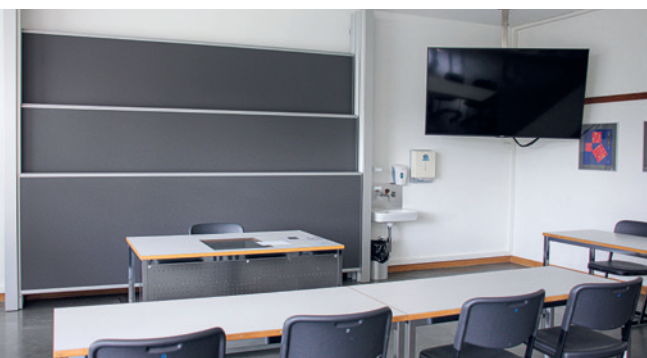
Bei Säulenwandtafeln werden die drei Tafeln beidseitig in Säulen geführt und brauchen nur wenig Raumtiefe.
